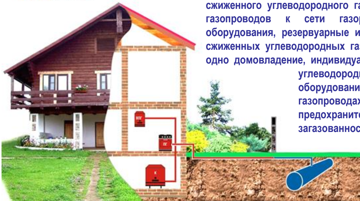
Схема разделения сетей газораспределительной организации и ВДГО домовладения
